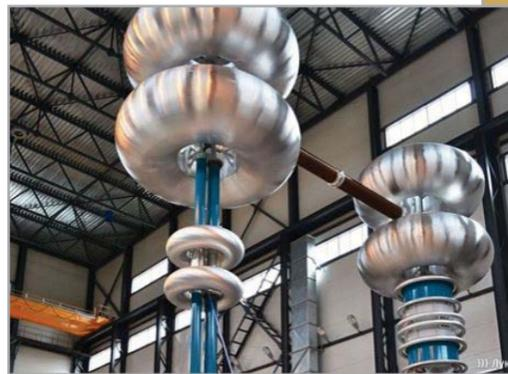
понентов испытательной системы WRM 2400/1200, таких как блок электропитания и возбуждающий трансформатор, позволяет проведение модернизации
