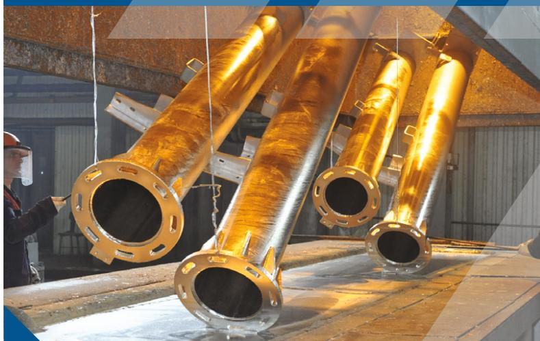
Линия горячего цинкования
